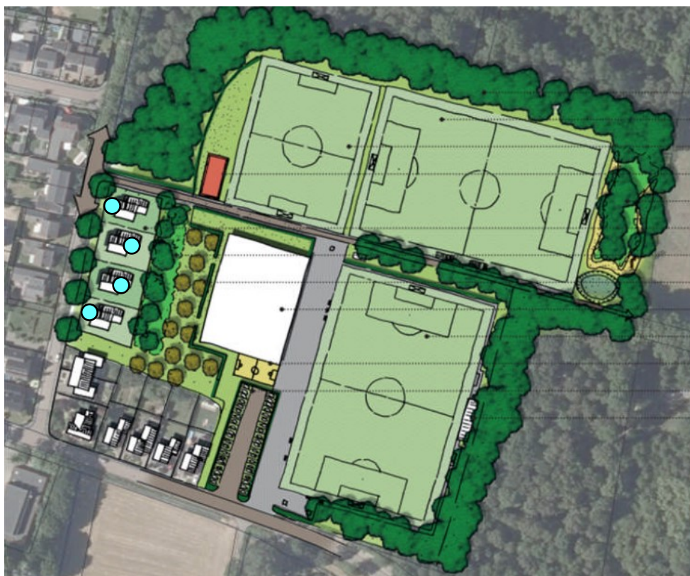
Afbeelding 6: Locaties permanente vleermuisverblijven in de spouwmuren met gripgaas (blauw) (Bron afbeelding: Haalbaarheidsonderzoek dorpsaccomodaties, 2022).
